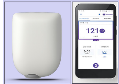
Şekil 40. Omnipod 5 pompa – pod ve kişisel diyabet yöneticisi
