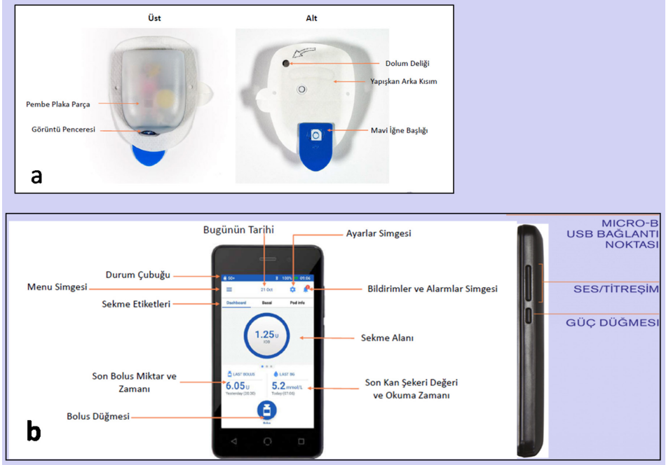
Şekil 29. Omnipod Dash- a. Pompanın üstten ve alttan görünümü, b. Kişisel diyabet yöneticisi
