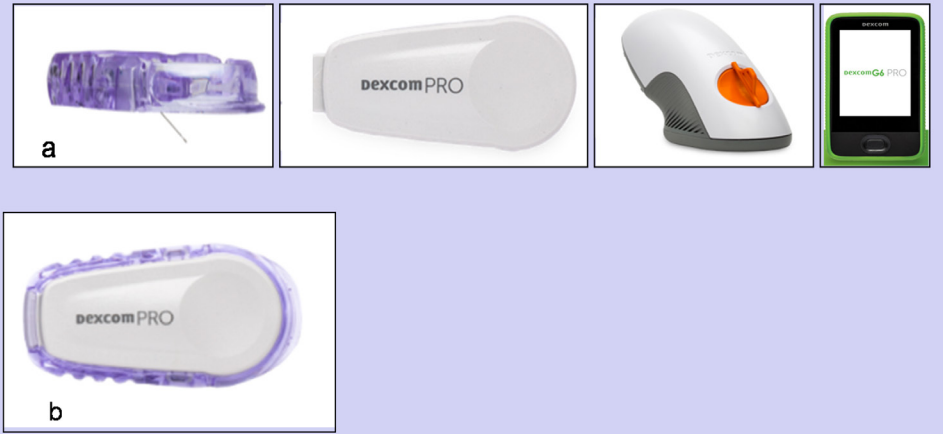
Şekil 5. a. Dexcom G6 Pro sensör, verici, aplikatör ve okuyucu, b. Sensör ve verici sabitlenmesi sonrası görünüm
